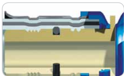
Prečni prerez PPSU spojnega elementa
